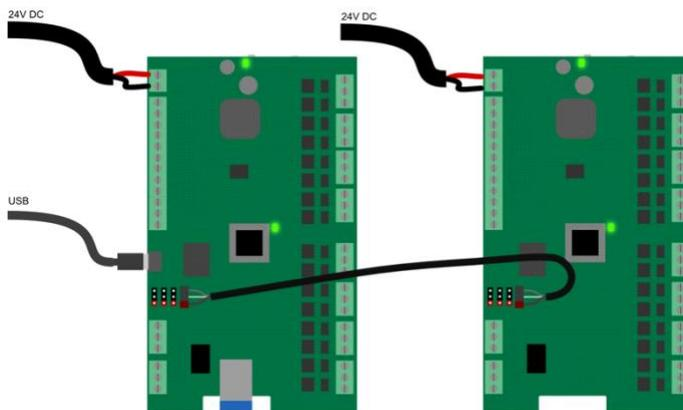
Abbildung 1: Verbindung des Erweiterungsmoduls
